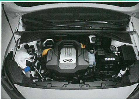
*Der Motorraum des Ioniq Elektro mit nahezu kompletter Hochvolttechnik: E-Maschine, Leistungselektronik, Klimakompressor, AC/DC-Wandler, usw.*
